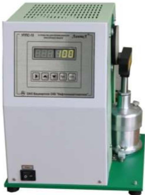
Автоматическое перемешивание образцов
