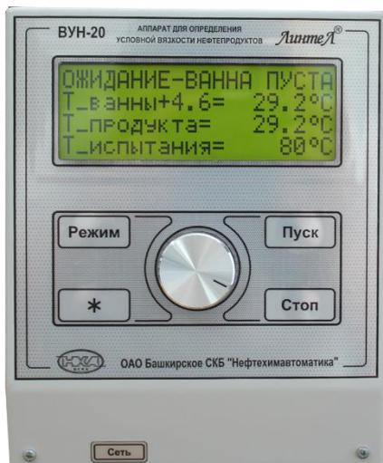
Контроль процесса испытания. Отображение на дисплее важных параметров процесса испытания
