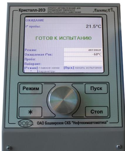
Цветной контрастный TFT дисплей и блок управления обеспечивают простой и интуитивно понятный интерфейс
