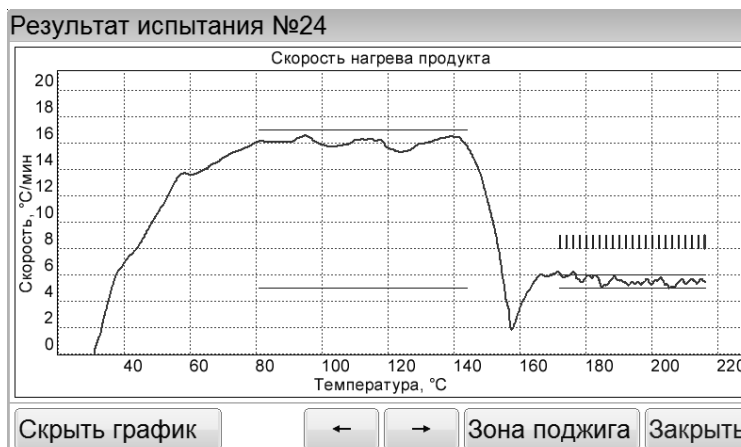
Рисунок 12 – Окно «Результат испытания»: график скорости нагрева
