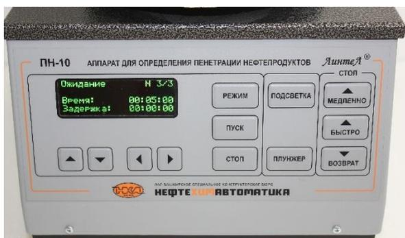
Отображение на дисплее в режиме ожидания: номера последнего проведенного испытания; заданного количества испытаний; скорости подъема стола; заданного времени пенетрации; заданного времени задержки
