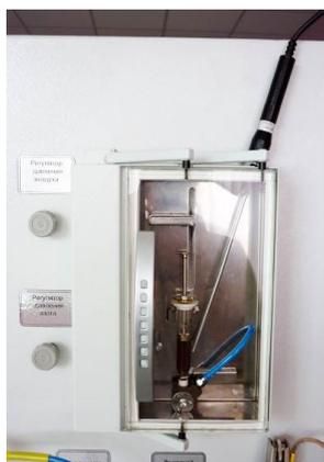
Для проверки показаний аппарата при аттестации, калибровки встроенных датчиков температуры предусмотрена возможность установки образцового термометра
