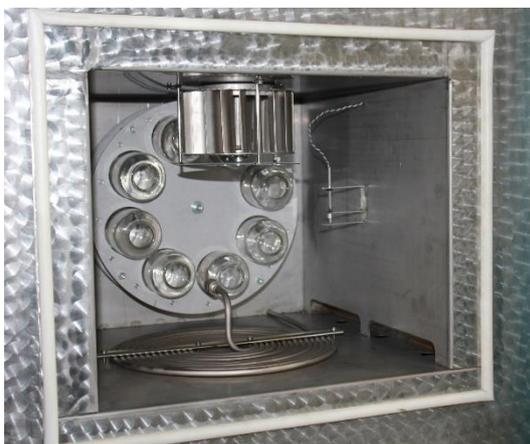
Встроенные терморегулятор для поддержания заданного температурного режима, вентилятор, ротаметр и компрессор для создания и поддержания требуемых условий испытания
