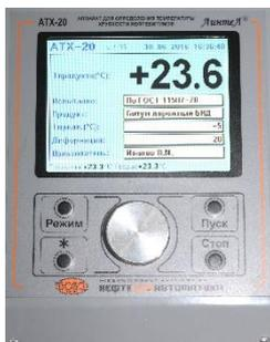
❖ Встроенная система охлаждения на базе элементов Пельтье обеспечивает автоматическое поддержание условий испытания в соответствии с выбранным методом и минимальную температуру в модуле охлаждения -45 °С. Аппарат не требует подключения внешнего криостата, не использует дополнительные расходные материалы и токсичные хладагенты
