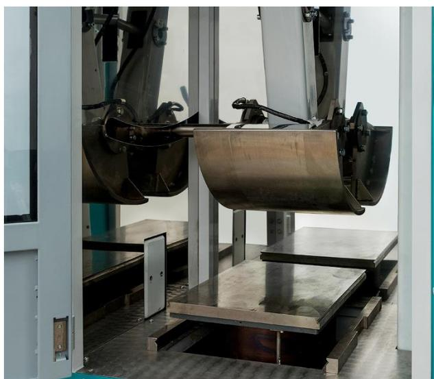
Автоматическое определение касания поверхности образца смеси в форме для испытания, поддержание заданной нагрузки на поверхность смеси и уплотнение образца в соответствии с программой испытания
