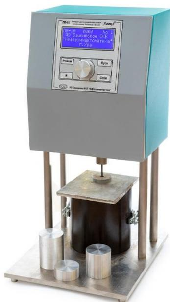
Аппарат комплектуется плоскопараллельными дисками высотой 25, 60, 80 мм
